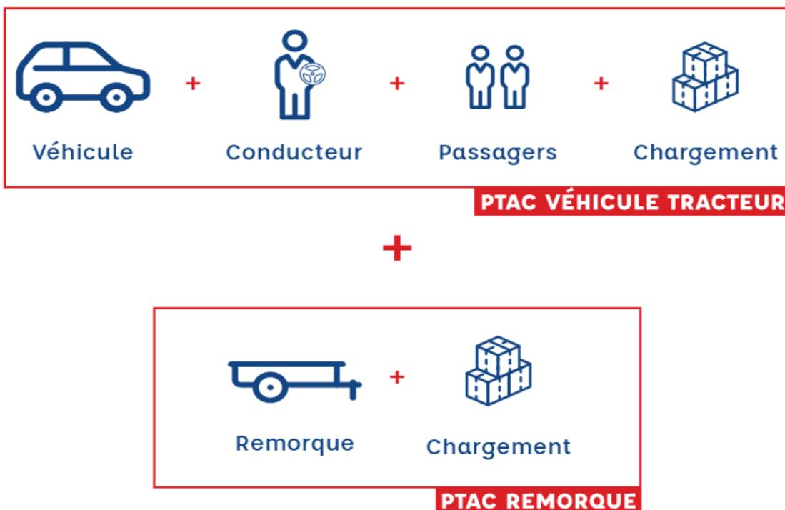
**LE POIDS TOTAL ROULANT RÉEL** de votre ensemble de véhicule est calculé sur le moment, c'est-à-dire en fonction des chargements qui sont réellement présents sur les véhicules, non pas en fonction de la somme des PTAC de chaque véhicule.
